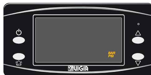
**Presión 1:** con ▲ o ▼ modificar hasta que aparece el valor de calibración deseado. Luego presionar el pulsador de calibración.
