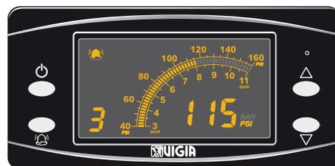
**Presión de entrada:** De fábrica se provee regulado a 80 PSI (5.5 BAR) y no debe ser modificado.
