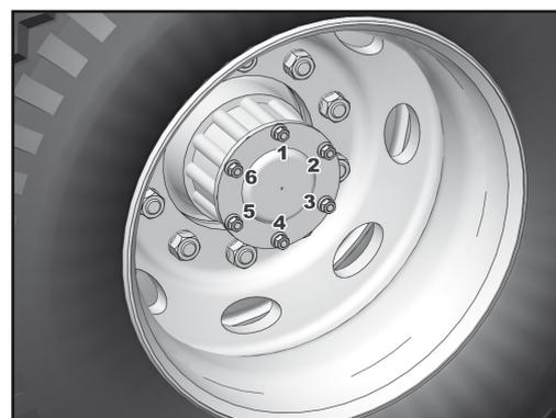
c) Reemplazar las tuercas o bulones determinados en la segunda columna del cuadro anterior por los espárragos provistos con el equipo.
