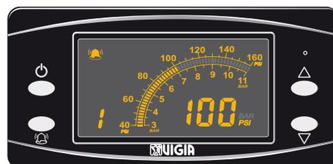
**Presión 2:** con ▲ o ▼ modificar hasta que aparece el valor de calibración deseado. Luego presionar el pulsador de calibración.
