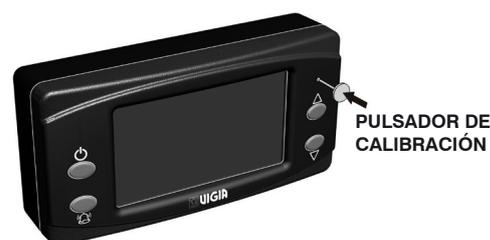
**Unidad de medida:** con ▲ o ▼ seleccionar la unidad de medida BAR o PSI. Luego presionar el pulsador de calibración.
