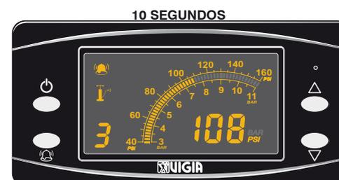
**Aclaración:** Si el equipo se encuentra en modo manual y se produce una pérdida de aire en cualquiera de las presiones, se pasa automáticamente a modo secuencial, indicando la o las presiones que tienen pérdida.
