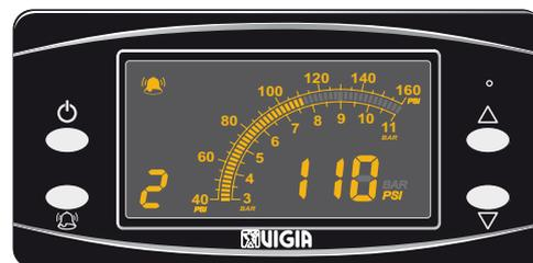
**Presión 3:** con ▲ o ▼ modificar hasta que aparece el valor de calibración deseado. Luego presionar el pulsador de calibración.
